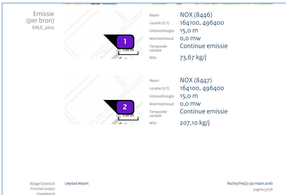
Figuur 6: Bron 1 en 2 van de referentiesituatie volgens de AERIUS-berekening uit 2016 t.b.v. PAS-melding. Warmte-inhoud is 0,0 MW.
