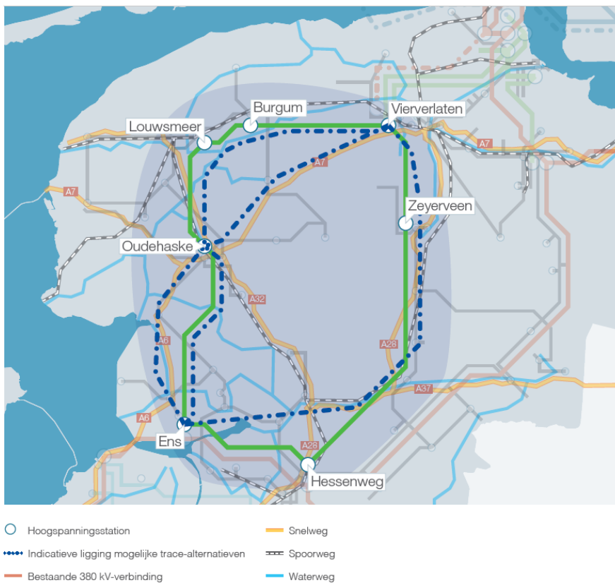
Figuur 1-1 Zoekgebied 380 kV-verbinding tussen Vierverlaten en Ens
